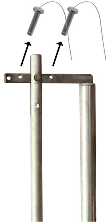
2. Die Arretierbolzen mit Auszieh-sicherung entnehmen
